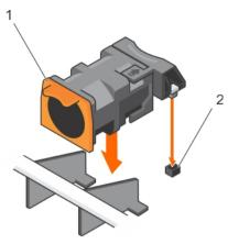
Figure 46. Installing a cooling fan
