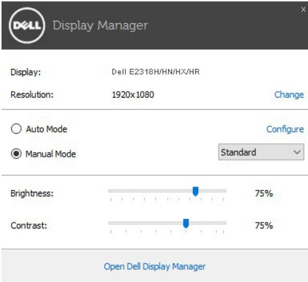
El cuadro de dialogo Configuración rápida también proporciona acceso a la interfaz de usuario avanzada de Dell Display Manager, que se utiliza para ajustar funciones básicas, configurar el modo automático y acceder a otras funciones.
