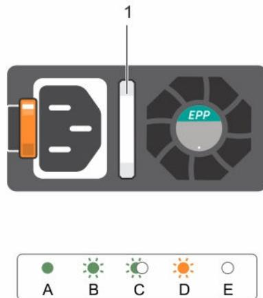
Abbildung 8. Statusanzeige des Wechselstrom-Netzteils
