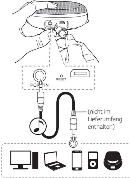
1. Schließen Sie das Zusatzgerät am Portable In-Anschluss des Gerätes an.
