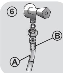
● **AQUAPROTECT-TUBE D'ALIMENTATION AVEC PROTECTION** (**fig. 6**): si de l'eau fuit à partir du tuyau "A", la gaine de confinement transparent "B" va contenir de l'eau pour permettre le cycle de lavage de se terminer. À la fin du cycle, contactez le service à la clientèle pour remplacer le tuyau d'alimentation.
