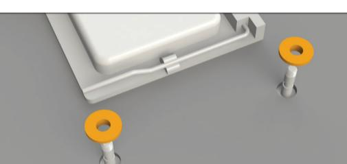
Fixez la plaque arrière en utilisant les entretoises-C (12), poussez celles-ci sur les vis M3x15 AMD (10) jusqu'à ce qu'elles se clipsent.
