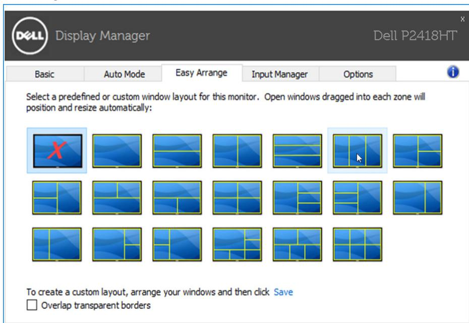
Para criar um layout de janela personalizada, dimensione e posicione as janelas (máximo 10) na área de trabalho e clique no link economia em Easy Arrange. The size and position of the windows is saved as a custom layout and the custom layout icon is created.
