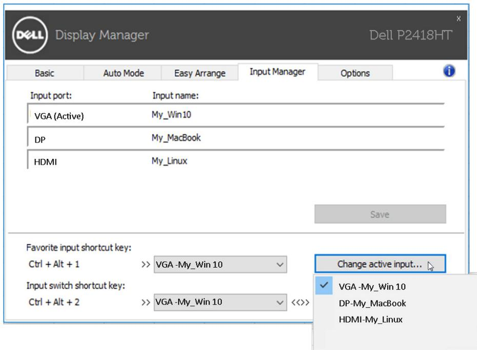
**NOTA:** DDM comunica com o seu monitor mesmo quando o monitor estiver mostrando vídeo de outro computador. Você pode instalar DDM sobre o PC você frequentemente usa e controla entrada que transfere deste. Você pode instalar também DDM em outros PCs conectados ao monitor .
