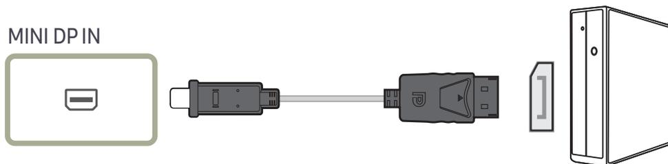
— Pour afficher un format 3840 x 2160 à 60 Hz, utilisez un câble DP prenant en charge le format 3840 x 2160 à 60 Hz. Assurez-vous que la carte graphique de la source MINI DP prend en charge le format 3840 x 2160 à 60 Hz.
