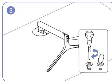
Tournez complètement la vis de connexion dans le bas du pied, de façon à ce qu'il soit solidement fixé.
