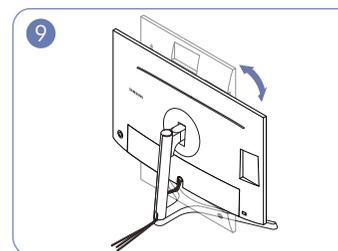
Pivotez l'appareil en position horizontale.
