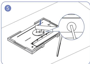
Placez le col du socle de l'écran sur l'appareil comme indiqué par les positions des fixations.
