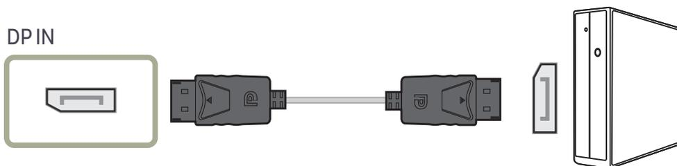
— Pour afficher un format 3840 x 2160 à 60 Hz, utilisez un câble DP prenant en charge le format 3840 x 2160 à 60 Hz. Assurez-vous que la carte graphique de la source DP prend en charge le format 3840 x 2160 à 60 Hz.
