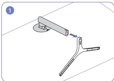
Insérez le connecteur du pied dans le pied, dans le sens indiqué sur l'illustration.
