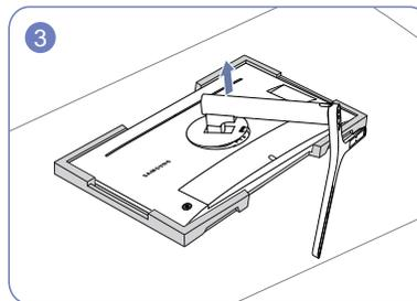
Après avoir tourné le col du socle de l'écran de 10° dans le sens inverse des aiguilles d'une montre, soulevez le col du socle pour le détacher de l'appareil.
