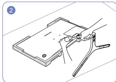
Pour démonter le socle du moniteur, appuyez sur la partie inférieure du moniteur d'une main, puis tirez et faites sortir latéralement le socle de l'autre main, comme montré sur l'illustration.
