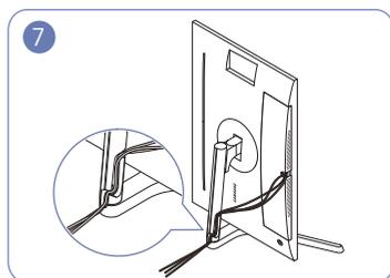
Placez les câbles correspondants dans le support du col de socle. Ne déroulez pas le câble. Nous recommandons de mettre les trois câbles dans un seul support.
