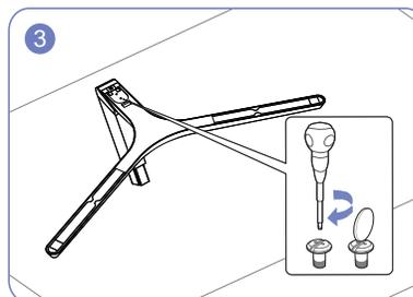
Tournez complètement la vis de connexion dans le bas du pied, de façon à ce qu'il soit solidement fixé.
