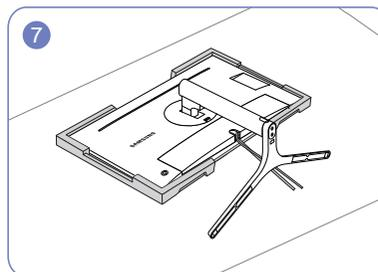
Installez la PARTIE SECONDAIRE DU CAPOT ARRIÈRE après avoir connecté l'alimentation électrique et le câble de données.
