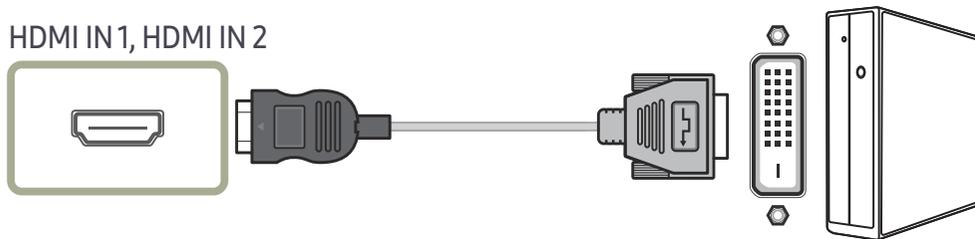
— La fonction audio n'est pas prise en charge si l'appareil source est connecté à l'aide du câble HDMI-DVI.
