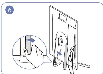
Ouvrez le CAPOT GAUCHE DU COL DE SOCLE et pivotez la partie ouverte vers le bas.
