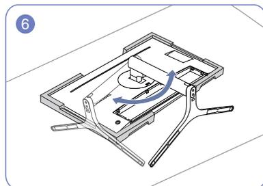
Tournez le col du socle de l'écran de 90° dans le sens des aiguilles d'une montre pour assurer la mise en place du col du socle de l'écran.
