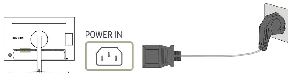
Pour utiliser l'appareil, branchez le câble d'alimentation à une prise de courant et au port **POWER IN** de l'appareil.
