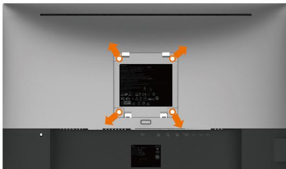
**OBSERVAÇÃO:** Use parafusos M4 x 10 mm para conectar o monitor ao kit para montagem na parede.
