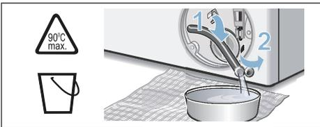
5. Pumpendeckel vorsichtig abschrauben, Restwasser kann auslaufen. Innenraum, Gewinde des Pumpendeckels und Pumpengehäuse reinigen. Das Flügelrad der Laugenpumpe muss sich drehen lassen.
