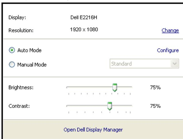
La boîte de dialogue Réglages rapides permet aussi d'accéder à l'interface d'utilisateur avancée du Gestionnaire d'affichage Dell, qui permet de régler les Fonctions basiques, de configurer le Mode auto et d'accéder à d'autres fonctions.
