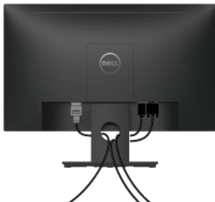
Dopo aver fissato tutti i cavi al monitor e al computer, (Si veda [Connessione del monitor](#) per i collegamenti dei cavi), usare il passacavi per organizzare i cavi in maniera ordinata, come mostrato sopra.
