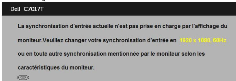
Cela signifie que l'écran ne peut pas se synchroniser avec le signal reçu depuis l'ordinateur. Voir **Spécifications du moniteur** pour vérifier les limites de la fréquence horizontale et verticale pour ce moniteur. Le mode recommandé est 1920 x 1080.
