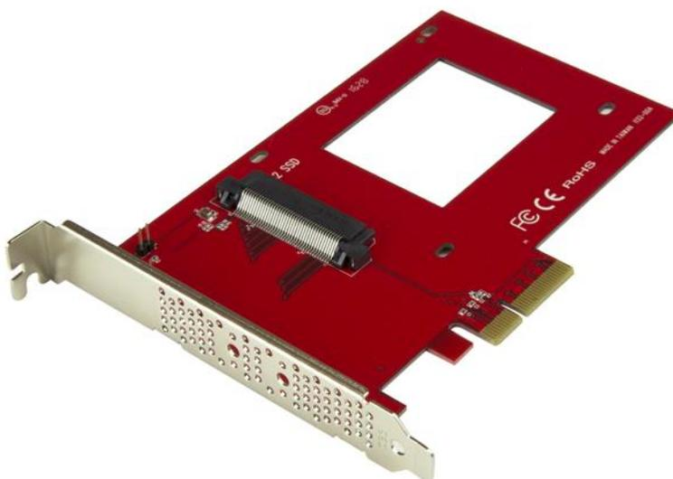
Accesso ultrarapido ai dati grazie all'aggiunta di un'unità SSD NVMe U.2 al computer. Questo adattatore U.2 a PCIe permette di aggiungere un'unità SSD NVMe da 2,5" U.2 ad alta velocità (PCIe su 4 linee), ad esempio l'unità Intel® serie 750, a un PC che dispone di uno slot di espansione PCI Express x4.
