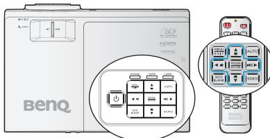
Appuyez sur ▼/▲ sur le projecteur ou la télécommande pour afficher la page Trapèze 2D. Appuyez sur ▲/▼ pour régler les valeurs verticales de -30 à 30. Appuyez sur ◀/▶ pour régler les valeurs horizontales de -30 à 30.
