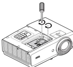
10. Connectez le connecteur de la lampe et placez-le comme sur l'illustration avant la réinstallation du couvercle du compartiment de la lampe.
