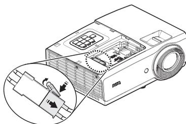
5. Desserrez les deux vis captives de fixation de la lampe.
