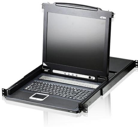
Los switches KVM serie CL1016 son unidades de control que permiten acceso a múltiples computadores desde una única consola. Una sola unidad de CL1016 puede controlar hasta 16 servidores. Hasta 15 switches KVM adicionales pueden conectarse en cascada Daisy Chain con el CL1016, así hasta 256 computadores pueden ser administrados desde una sola consola.
