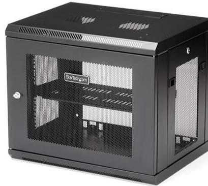
Grazie a questo armadietto rack per server 9U è possibile installare le apparecchiature conformi alla specifica EIA-310 su una parete. Il box esterno è compatibile con una capacità di carico massima di 90 kg e una profondità di installazione regolabile fino a 38,1 cm.
