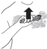
**2** Strekk huden med den ledige hånden og før barbermaskinen mot hårets vekstretning for å oppnå en mest mulig effektiv trim. Kontroller at overflaten av friserkammen alltid er i kontakt med huden.
