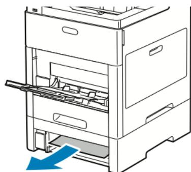
4. Für den gleichen Behälter an der Druckerrückseite die Stauzugangsabdeckung ausfindig machen. Die Abdeckung öffnen und sämtliches gestaute Material entfernen.
