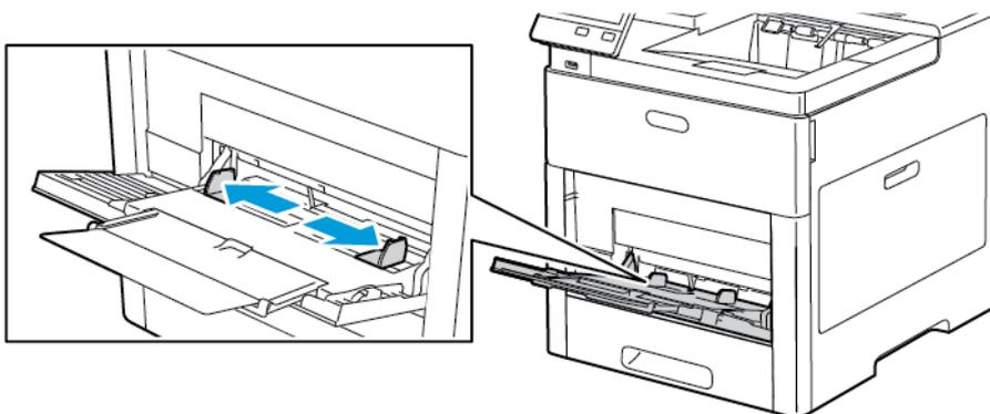
4. Etiketten so in die Zusatzzufuhr einlegen, dass die Vorderseite nach oben weist und die Oberkante des Bogens zuerst eingezogen wird.
