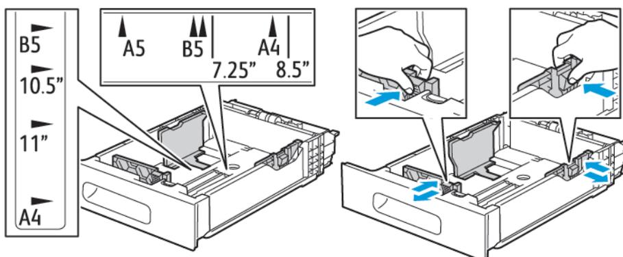
3. Um für Material im Format Legal die Behältervorderseite zu erweitern, den grünen Entriegelungshebel drücken und den Behälter herausziehen.
