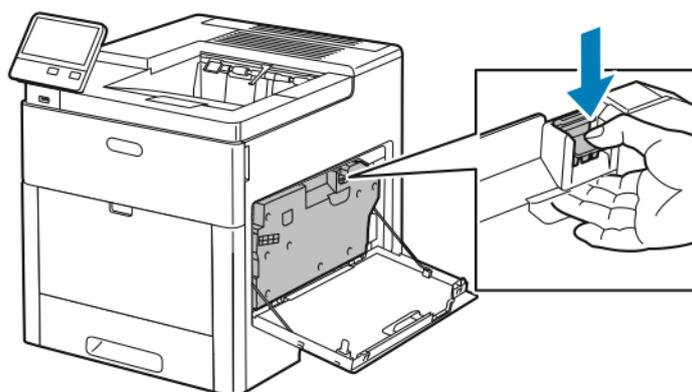
4. Den Behälter zum Herausnehmen an der Oberseite ankippen und herausziehen. Behälter aufrecht halten, damit kein Toner verschüttet wird.
