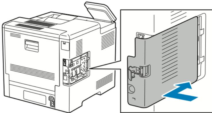
7. Um die Abdeckung zu verriegeln, den Griff zur Druckervorderseite hin umlegen und dann einschieben, bis er einrastet.
