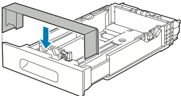
6. Material in den Behälter einlegen, dann Behälter wieder in den Drucker einschieben.
