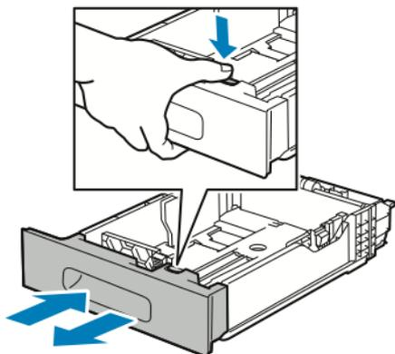
4. Zum Ausziehen des Behälters für längeres Material die Behälterrückseite mit einer Hand festhalten. Mit der anderen Hand auf die Entriegelungsklinke vorne am Behälter drücken und die Enden nach außen ziehen, bis sie einrasten.
