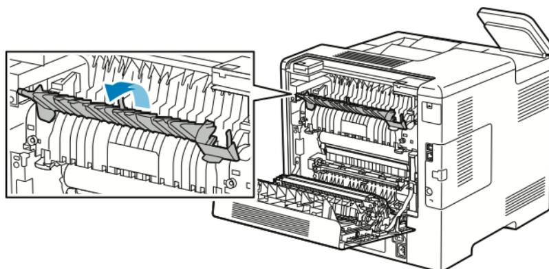
3. Gestautes Material an der Rückseite des Druckers entfernen.
