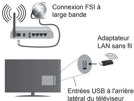
Un routeur sans fil-N (IEEE 802.11a/b/g/n) avec des bandes simultanées de 2,4 et 5 GHz est conçu pour augmenter la bande passante. Ces fonctions sont optimisées pour une transmission vidéo en HD plus
