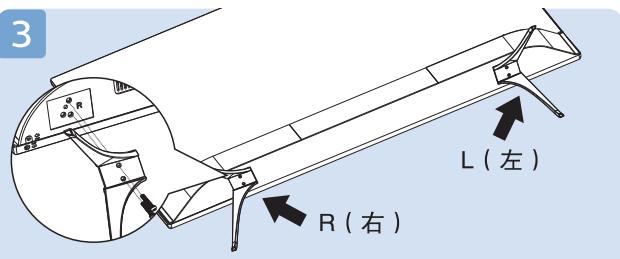
\* 将底座按照图示对齐放置（注意区分左右支撑），“R”、“L”在底座上有标识。
