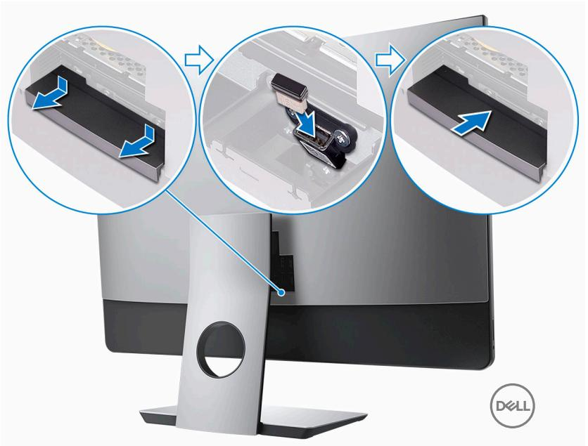
3 Schließen Sie das Stromkabel an.
