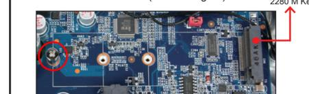
2. Instale la tarjeta M.2 en la ranura M Key y asegúrela con un tornillo.
