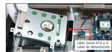
4. Fije el disco duro o la SSD con el soporte en la carcasa mediante los cuatro tornillos.
