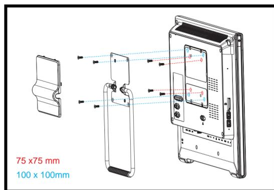
Si desea montar el X50V6 en una pared, primero debe retirar la cubierta de la parte posterior. Para ello, afloje los 4 tornillos de la fijación del soporte. Fije el X50V6 en un soporte/brazo VESA adecuado (no incluido en el pack). Tenga en cuenta el manual de montaje del fabricante pertinente.
