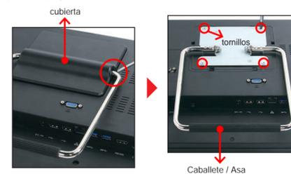
2. Retire los 4 tornillos para desmontar la tapa de la carcasa.
