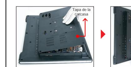
2. Fije el pie de apoyo y la cubierta con 8 tornillos.
