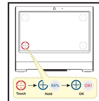
Tras finalizar la calibración de los 4 puntos, presione "OK".
