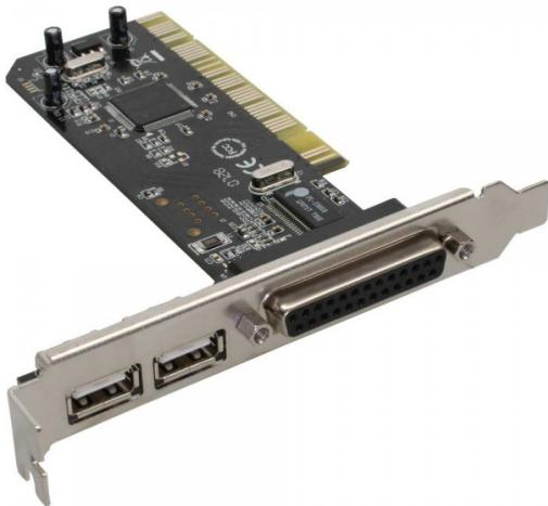
Schnittstellenkarte, InLine®, USB 2.0 + parallel, PCI. Diese PCI Karte erweitert Ihren PC um einen externen Parallelen Port sowie um 2 USB 2.0 Ports. Sie können an die Karte verschiedene parallele Geräte wie z.B. Scanner, Drucker und zudem auch USB Geräte anschließen.
