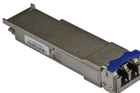
El modelo QSFP40LR4ST es un transceptor QSFP+ por fibra óptica, conforme a las normas MSA, diseñado, programado y probado para su funcionamiento con enrutadores y conmutadores 40GBASE-LR4 compatibles con MSA. El transceptor QSFP+ admite una distancia máxima de hasta 10km y conectividad fiable a 40GbE a través de cableado de fibra.
