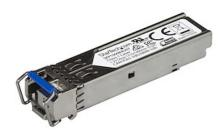
El modelo SFP1000BXUST es un transceptor SFP ascendente por fibra óptica compatible con MSA, que se puede emparejar con el modelo SFP1000BXDST de StarTech.com. Ha sido diseñado, programado y probado para su funcionamiento con enrutadores y conmutadores 1000BASE-BX compatibles con MSA. El transceptor SFP admite una distancia máxima de hasta 10km y conectividad fiable a 1GbE a través de cableado de fibra.
