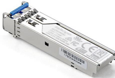
SFP1000EXST è un ricetrasmittitore SFP in fibra conforme a MSA progettato, programmato e testato con switch e router MSA compatibili con 1000BASE-EX. Il modulo ricetrasmittitore SFP supporta una distanza massima fino a 40 km e offre una connettività da 1 GbE affidabile tramite cavo in fibra.
