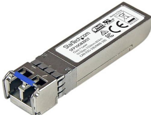
El modelo SFP10GBZRST es un transceptor SFP por fibra óptica, conforme a las normas MSA, diseñado, programado y probado para su funcionamiento con enrutadores y conmutadores 10GBASE-ZR compatibles con MSA. El módulo transceptor SFP+ admite una distancia máxima de hasta 80km y conectividad fiable a 10GbE a través de cableado de fibra. **Especificaciones técnicas:**
