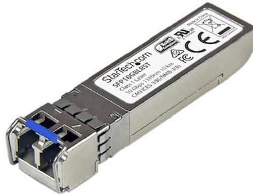
El modelo SFP10GBLRST es un transceptor SFP por fibra óptica, conforme a las normas MSA, diseñado, programado y probado para su funcionamiento con enrutadores y conmutadores 10GBASE-LR compatibles con MSA. El transceptor SFP+ admite una distancia máxima de hasta 10km y conectividad fiable a 10GbE a través de cableado de fibra. <b>Especificaciones técnicas: </b>
