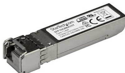
El modelo SFP10GBBXUST es un transceptor SFP ascendente por fibra óptica compatible con MSA, que se puede emparejar con el modelo SFP10GBBXDST de StarTech.com. Ha sido diseñado, programado y probado para su funcionamiento con enrutadores y commutadores 10GBASE-BX compatibles con MSA. El transceptor SFP+ admite una distancia máxima de hasta 10km y conectividad fiable a 10GbE a través de cableado de fibra. <b>Especificaciones técnicas: </b>
