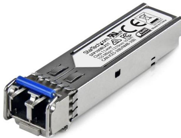
Le SFP100BLXST est un transceiver SFP à fibre optique conforme aux normes MSA qui est conçu, programmé et testé pour fonctionner avec des commutateurs et routeurs 100BASE-LX conformes aux normes MSA. Le module de transceiver SFP prend en charge une distance maximale de 10 km et fournit une connectivité Ethernet 100 Mo fiable via un câblage de fibre optique.
