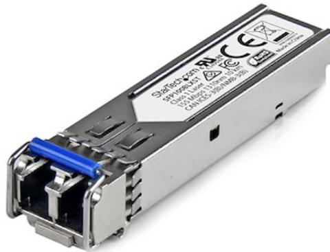
El modelo SFP100BLXST es un transceptor SFP por fibra óptica, conforme a las normas MSA, diseñado, programado y probado para su funcionamiento con enrutadores y conmutadores 100BASE-LX compatibles con MSA. El módulo transceptor SFP admite una distancia máxima de hasta 10km y conectividad fiable Ethernet a 100Mb a través de cableado de fibra. <b>Especificaciones técnicas: </b>
