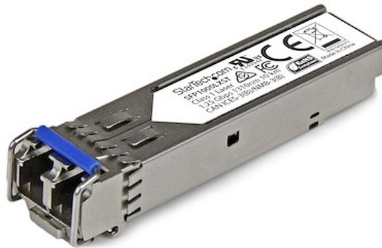
El modelo SFP1000LXST es un transceptor SFP por fibra óptica, conforme a las normas MSA, diseñado, programado y probado para su funcionamiento con enrutadores y conmutadores 1000BASE-LX compatibles con MSA. El transceptor SFP admite una distancia máxima de hasta 10km y conectividad fiable a 1GbE a través de cableado de fibra. <b>Especificaciones técnicas: </b>
