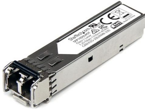
Der SFP1000LHST ist ein MSA-konformer SFP-Transceiver, der speziell für die Arbeit mit 1000BASE-LH-kompatiblen MSA-Switches und -Routern entwickelt, programmiert und getestet wurde. Das SFP-Transceiver-Modul unterstützt eine maximale Entfernung von bis zu 40 km und bietet eine zuverlässige 1-GbE-Konnektivität über Glasfaserkabel. **Technische Daten:**
