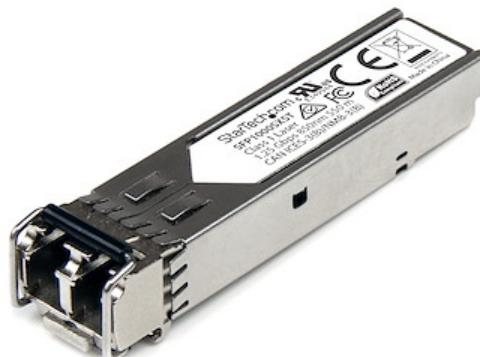
Le SFP1000SXST est un transceiver SFP à fibre optique conforme aux normes MSA qui est conçu, programmé et testé pour fonctionner avec des commutateurs et routeurs 1000BASE-SX conformes aux normes MSA. Le module de transceiver SFP prend en charge une distance maximale de 550 m et fournit une connectivité 1 GbE fiable via un câblage de fibre optique. <b>Spécifications techniques :</b>
