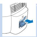
2 Retirez le cordon d'alimentation du compartiment de rangement à l'arrière de l'appareil.
