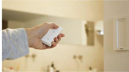
O interruptor de regulação da intensidade da luz Philips Hue funciona como um interruptor de parede e regulador normal, mas melhor. Além de ser possível a montagem com parafusos ou fita adesiva forte, pode remover o controlo magnético e levá-lo para qualquer lugar.
