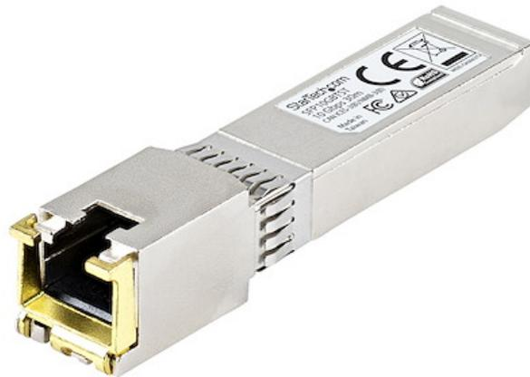
Le SFP10GBTST est un transceiver SFP en cuivre conforme aux normes MSA qui est conçu, programmé et testé pour fonctionner avec des commutateurs et routeurs 10GBASE-T conformes aux normes MSA. Le module de transceiver SFP+ prend en charge une distance maximale de 30 m et fournit une connectivité 10 GbE fiable via un câblage en cuivre, une alternative plus économique à l'installation de câblage de fibre optique. <b>Spécifications techniques : </b>
