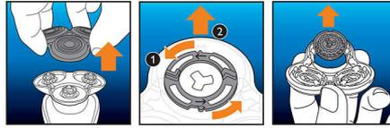
1. Öffnen Sie den Rasierer mit der Entriegelungstaste; 2. Entfernen Sie die Halterung durch Drehen der Verriegelung gegen den Uhrzeigersinn; 3. Nehmen Sie die alten Scherköpfe heraus, und setzen Sie vorsichtig die neuen ein; vergewissern Sie sich, dass die Scherköpfe genau ausgerichtet sind; 4. Ersetzen Sie die Halterung, und sichern Sie sie durch Drehen der Verriegelung im Uhrzeigersinn; 5. Wenn Sie den Scherkopf ordnungsgemäß schließen, hören Sie ihn einrasten.
