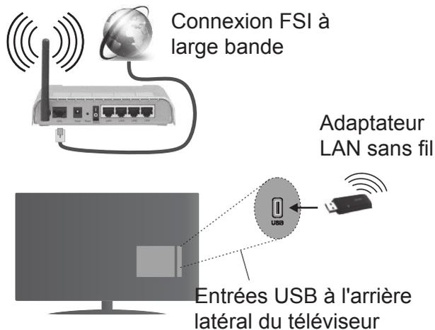
Un routeur sans fil-N (IEEE 802.11a/b/g/n) avec des bandes simultanées de 2,4 et 5 GHz est conçu pour augmenter la bande passante. Ces fonctions sont optimisées pour une transmission vidéo en HD plus claire et plus rapide et un transfert de fichiers et jeux sans fil faciles.
