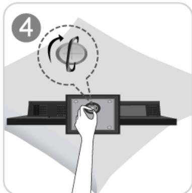
Tournez complètement la vis de connexion dans le bas du pied, de façon à ce qu'il soit solidement fixé.
