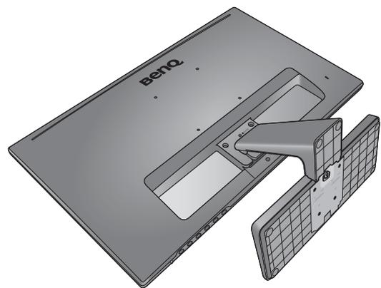
Inserte un objeto punzante como un destornillador en el orificio encima del brazo de soporte del monitor y luego empuje el destornillador contra el botón de liberación. A continuación tire del pedestal para separarlo del monitor.
