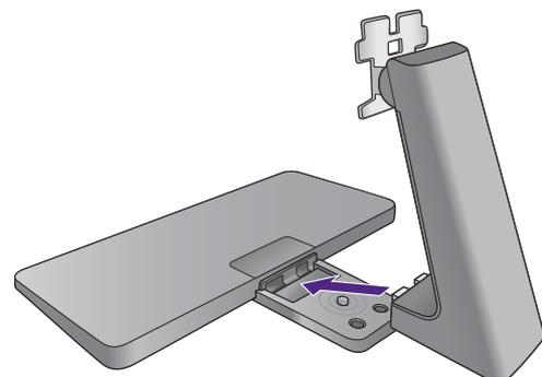
Apriete el tornillo de mariposa situado en la parte inferior de la base del monitor tal y como se muestra.
