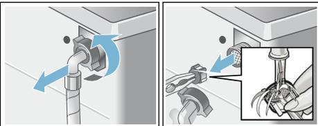
7. Schlauch anschließen und auf Dichtigkeit prüfen.
