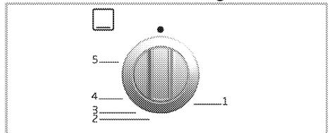
Il forno a gas si aziona con la manopola di controllo del forno a gas. In posizione off (superiore) l'alimentazione di gas è disattivata.
