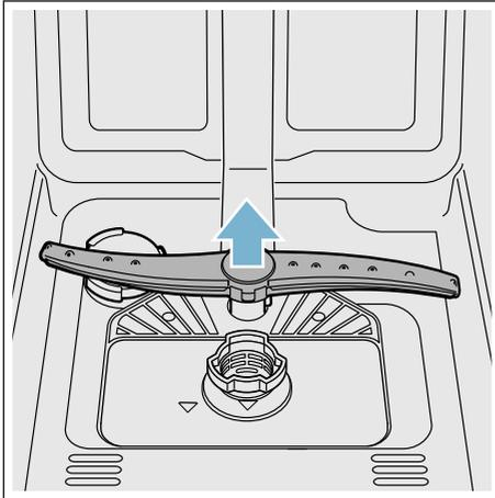
4. Sprüharme unter fließendem Wasser reinigen.
