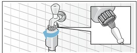
6. Bei Modellen Standard und Aqua-Secure Sieb an der Geräterückseite reinigen:
