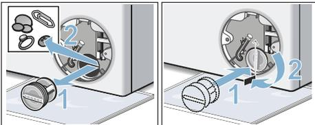
6. Service-Klappe einsetzen, einrasten und schließen.
