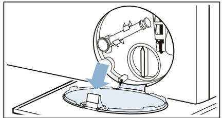
3. Entleerungsschlauch aus der Halterung nehmen. Verschlusskappe abziehen, Lauge in geeignetes Gefäß abfließen lassen. Verschlusskappe aufdrücken und Entleerungsschlauch in die Halterung einsetzen.
