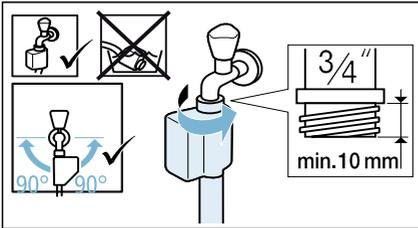
2. Wasserhahn vorsichtig öffnen und dabei Dichtheit der Anschlussstellen prüfen. Schraubverbindung steht unter Wasserleitungsdruck.
