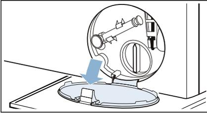
3. Am Ablaufschlauch befindet sich ein Saugnapf; den Saugnapf vom Ablaufschlauch abnehmen.
