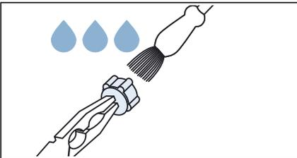
4. Schlauch anschließen und auf Dichtigkeit prüfen.
