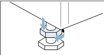
2. Ausrichtung des Geräts mit Wasserwaage überprüfen, evtl. korrigieren. Höhe durch Drehen des Gerätefußes verändern. Alle vier Gerätefüße müssen fest auf dem Boden stehen.
