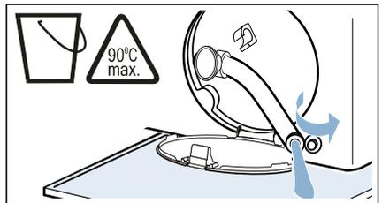
4. Pumpendeckel vorsichtig abschrauben, Restwasser kann auslaufen. Innenraum, Gewinde des Pumpendeckels und Pumpengehäuse reinigen. Das Flügelrad der Laugenpumpe muss sich drehen lassen.
