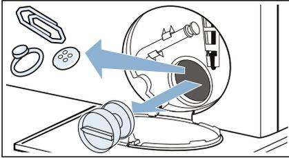
5. Pumpendeckel wieder einsetzen und verschrauben. Griff muss senkrecht stehen.
