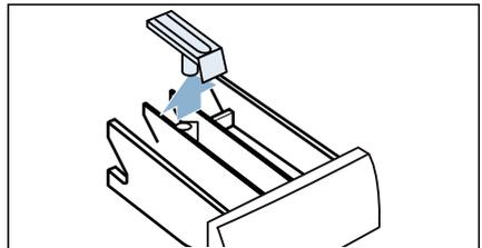
3. Einspülschale und Einsatz mit Wasser und Bürste reinigen und abtrocknen. Auch Gehäuse innen reinigen.
