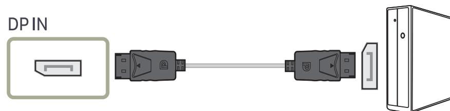
— Il est recommandé d'utiliser un câble DP d'une longueur inférieure à 1,5 m. L'utilisation d'un câble d'une longueur supérieure à 1,5 m peut affecter la qualité de l'image.
