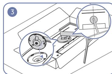
Placez le col du socle de l'écran sur l'appareil comme indiqué par les positions des fixations.
