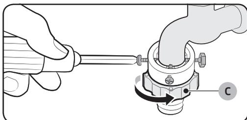
4. Insérez l'adaptateur dans le robinet d'eau, et resserrez les vis tout en levant l'adaptateur.
