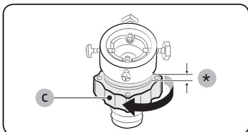
3. Tenez l'adaptateur et tournez la **partie (C)** dans le sens de la flèche pour le desserrer de 5 mm (\*).
