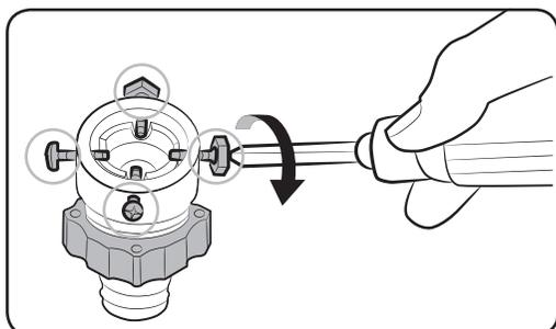
2. Utilisez un tournevis Philips pour desserrer les quatre vis sur l'adaptateur.
