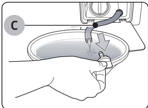
4. Ouvrez le capuchon du tube et laissez l'eau du **tuyau de Vidange d'urgence (C)** s'écouler dans le réservoir.
