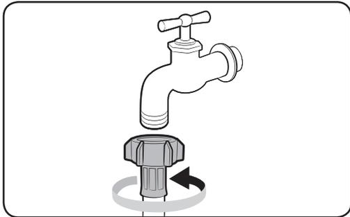
7. Si vous utilisez un robinet d'eau à vis, raccordez le tuyau d'eau au robinet d'eau tel qu'indiqué.
