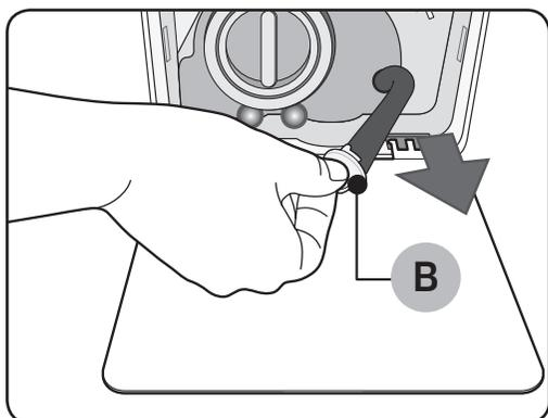
3. Placez un réservoir vide et assez grand autour du couvercle, et étirez le tube de vidange d'urgence autour du couvercle jusqu'au réservoir tout en tenant le **capuchon du tube (B)**.
