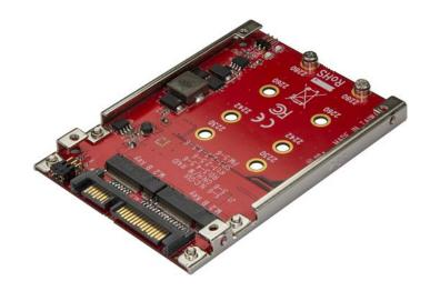
Beschleunigen Sie Ihre Systemleistung durch die Verbesserung der Kapazität, Geschwindigkeit und Sicherheit Ihres Datenspeichers. Mit diesem M.2-zu-SATA-Adapter für zwei Laufwerke können Sie zwei M.2-SATA-Laufwerke anstatt einem SATA-Platter-Laufwerk in einem einzelnen 2,5"-Laufwerksschacht installieren und so Ihre Speichermöglichkeiten durch die Konfiguration eines leistungsstarken RAID-Arrays erhöhen.
